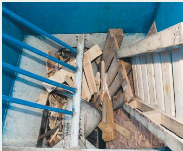
Trasiga pallar mals ner för att maximera fyllnadsgraden vid återvinning.
